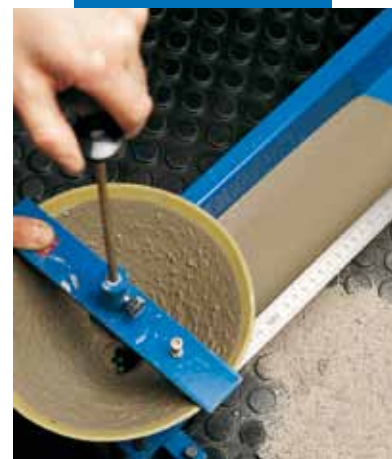
Изпитване на изтичането съгласно UNI 13395-2
