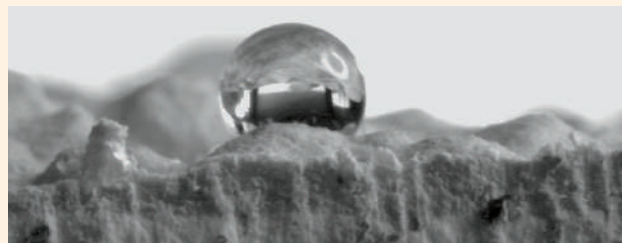
Водна капка върху хидрофобна обичайна мазилка.
